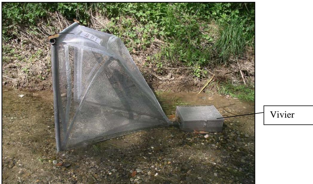
Figure 3 : Photo d'un piège expérimental de dévalaison des juvéniles d'ombre commun en place dans le lit du Nant de Sion.
