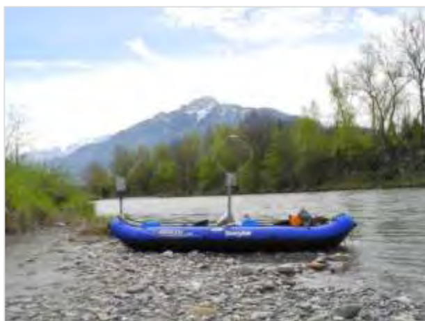
Figure 22 : matériel employé en prospection mobile en kayak
