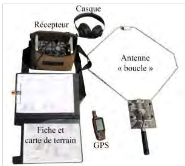
Figure 21 : matériel employé en prospection mobile à pied
