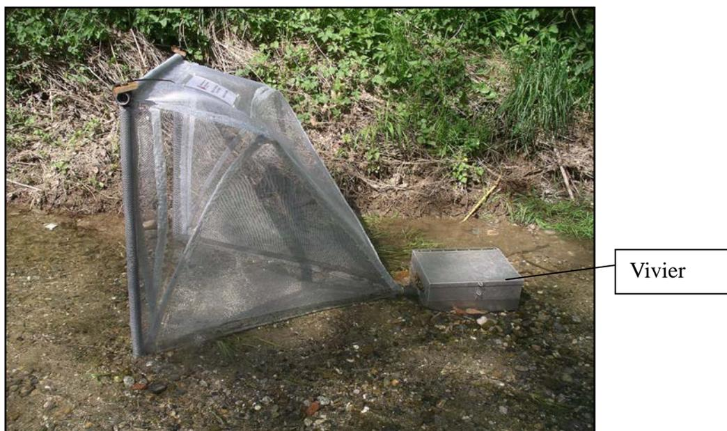
**Figure 8 :** Photo d'un piège de dévalaison des juvéniles d'ombre commun en place dans le lit du Nant de Sion.
