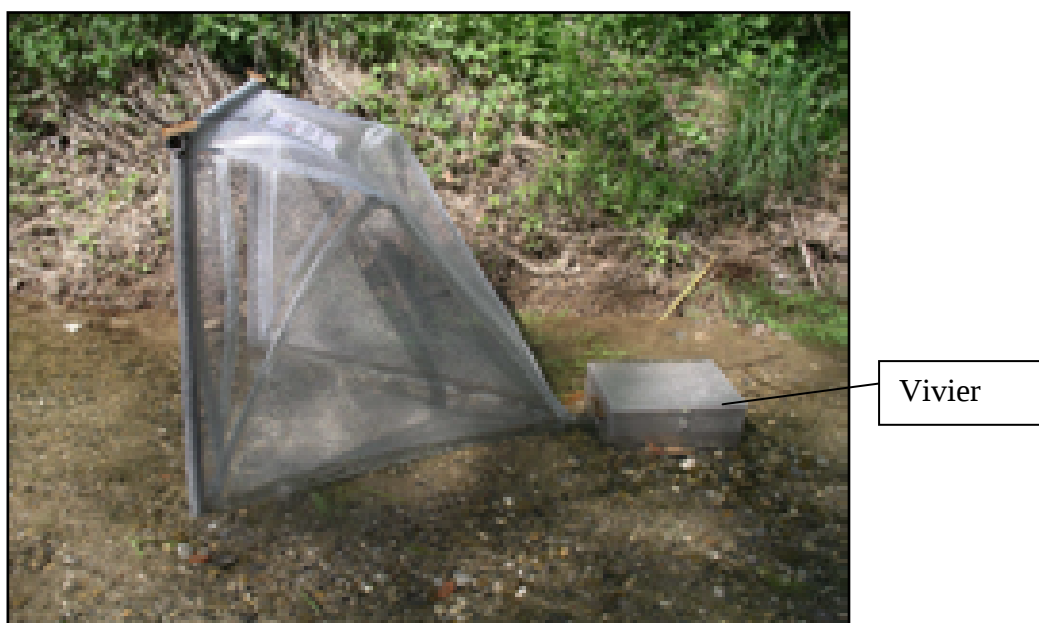
Figure 3 : Photo d'un piège expérimental de dévalaison des juvéniles d'ombre commun en place dans le lit du Nant de Sion.
