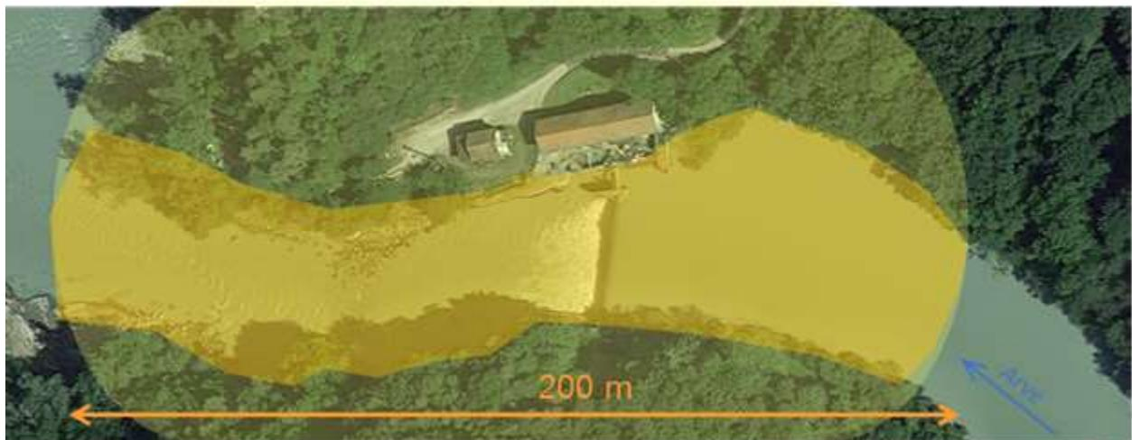
Figure 1: Zone de détection de l'antenne omnidirectionnelle de la station fixe radio implantée à la centrale EDF d'Arthaz-Pont-Notre-Dame.
