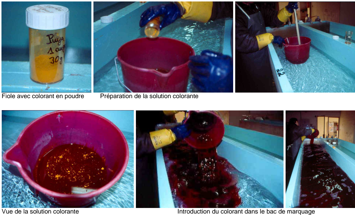
Figure 1 : Illustration photographique du mode opératoire du marquage
