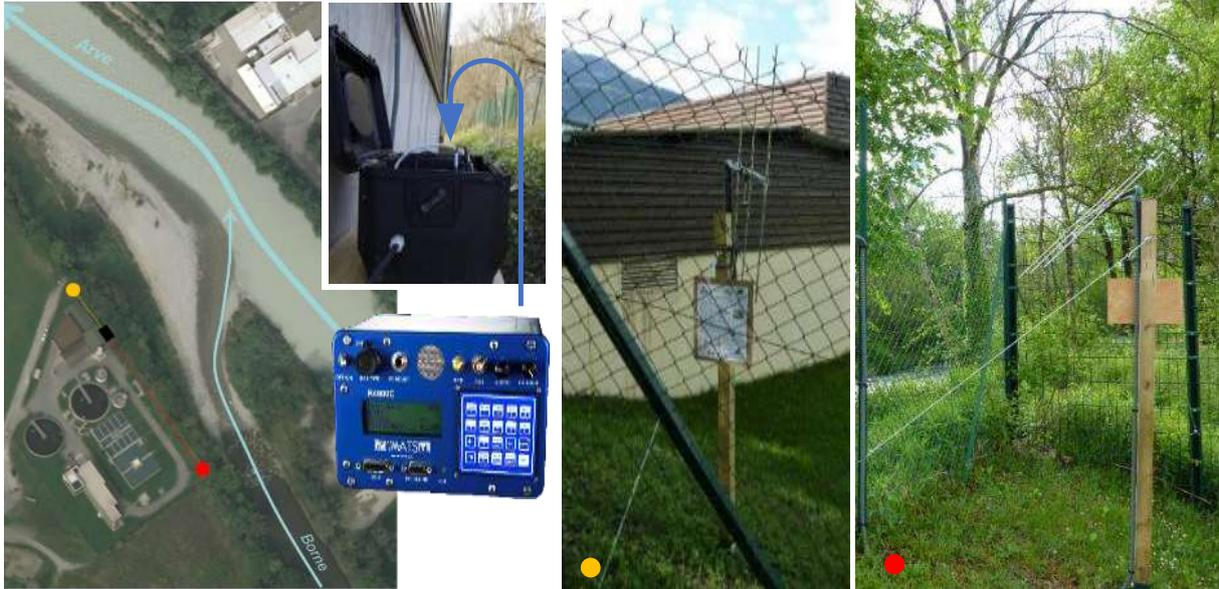
Figure 4 : Positionnement de la station radio fixe sur le site de la station d'épuration de Bonneville
