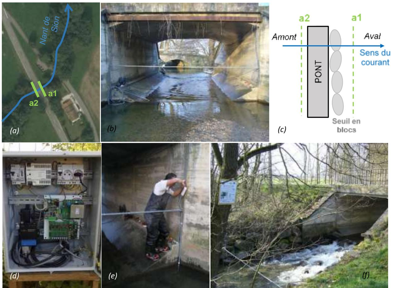
Figure 38 : Mise en place de la station PITtag du Nant de Sion ; (a) vue aérienne du site ; (b) antenne 2 vue depuis l'amont ; (c) schéma explicatif de l'implantation des 2 antennes ; (d) boîtier électrique relié au lecteur Oregon posé chez la propriétaire riveraine ; (e) branchement et réglage de l'antenne 2 ; (f) antenne 1 vue depuis l'aval avec le panneau d'information sur la station en rive gauche
