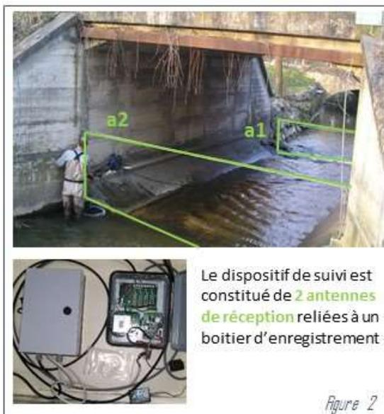
Le dispositif de suivi est constitué de 2 antennes de réception reliées à un boîtier d'enregistrement
