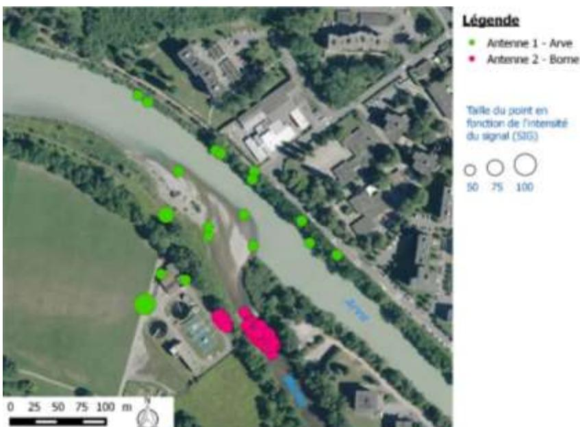
Figure 5 : Zones de détection des deux antennes Yagi directionnelles de la station fixe radio de Bonneville
