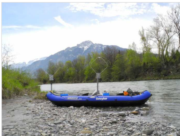
Figure 22 : matériel employé en prospection mobile en kayak
