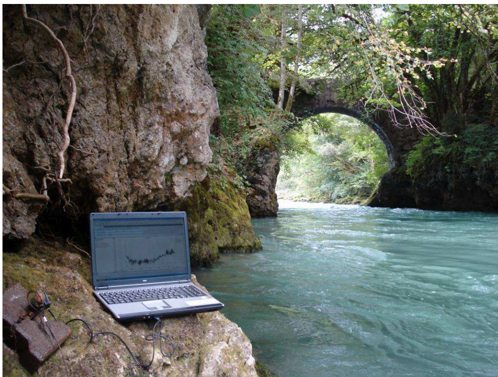
Photo 1: vue du dispositif permettant de maintenir la sonde thermique dans l'eau lors d'un déchargement intermédiaire des données sur la station BaD 07 ; la sonde est fixée sur un pavé, relié à la proie par un câble acier gainé fixé dans la roche à l'aide d'une cheville.
