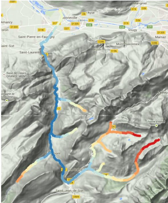
Figure 121 : Effet de l'intégration de la valeur d'habitat sur une modélisation du Borne (74). La valeur d'habitat testée ici agrège des données de qualité d'eau, de qualité hydrobiologique, des paramètres thermiques et le niveau d'artificialisation du cours d'eau. Le code couleur correspond à une analyse thématique sur le paramètre Y'_{rsh} , sans prise en compte des obstacles naturels et artificiels. Les couleurs froides (bleu) sont les tronçons à plus forte contribution au calcul.
