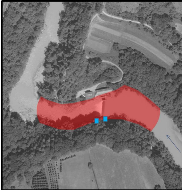
Figure 14 : Zone de détection de l'antenne omnidirectionnelle de la station fixe radio implantée à la centrale EDF d'Arthaz-Pont-Notre-Dame (linéaire couvert : 200 m). Les points bleus représentent la position des systèmes de détection PIT-tag.
