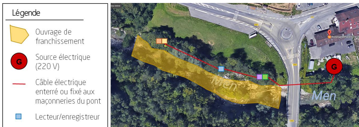
Figure 8 : Localisation de la source électrique privée et du cheminement du câble électrique enterré qui alimente le dispositif télémétrique.
