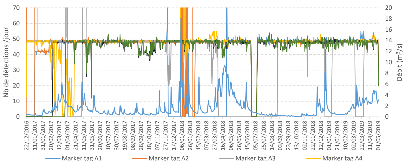
Figure 10 : Graphique du nombre de détections par jour des tags témoins permettant de vérifier le bon fonctionnement de chaque antenne
