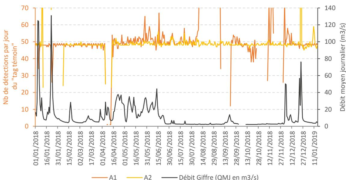
Figure 11 : Nombres de détections journalières des « tags témoins » décrivant le bon fonctionnement de chacune des 4 antennes constituant le dispositif de détection RFID du seuil du pont SNCF de Marignier, couplés au débit moyen journalier du Giffre enregistré à la station hydrologique V0154010 de la DREAL à Plan Séraphin.
