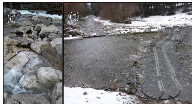
Figure 29: (a) Schéma de la disposition des antennes et leur dénomination, (b) sens de franchissement des poissons, (c) disposition de l'antenne (A4) amont rampe, (d) disposition de l'antenne amont rive gauche A6 (en l'absence de gros blocs, l'antenne a été fixée sur des bordures bétons, elles-mêmes maintenues au fond du lit par des fers à béton)
