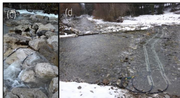
Figure 13: (a) Schéma de la disposition des antennes et leur dénomination, (b) sens de franchissement des poissons, (c) disposition de l'antenne (A4) amont rampe, (d) disposition de l'antenne amont rive gauche A6 (en l'absence de gros blocs, l'antenne a été fixée sur des bordures bétons, elles-mêmes maintenues au fond du lit par des fers à béton)
